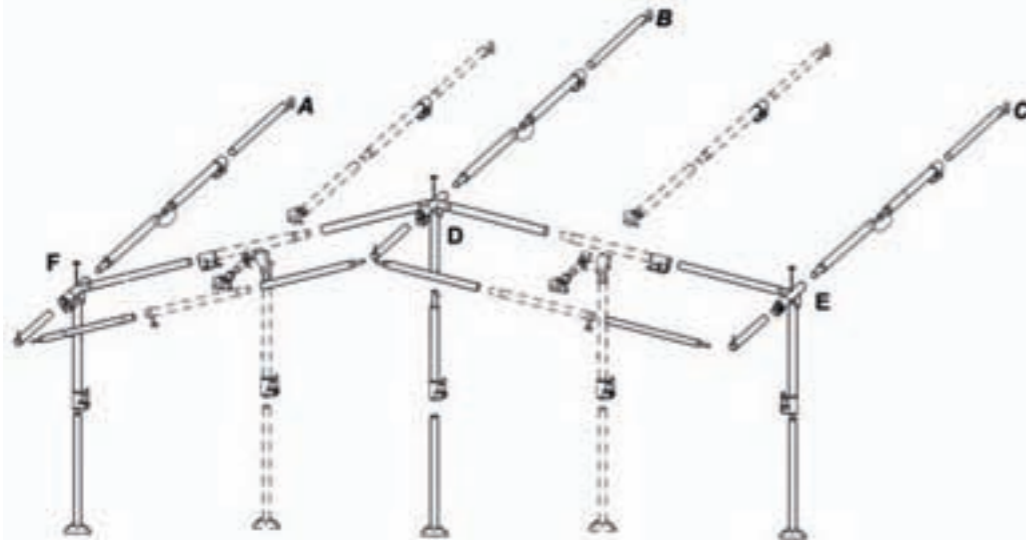
Plan des armatures d'un auvent avec avant-toit (renforcement des armatures incluses)
