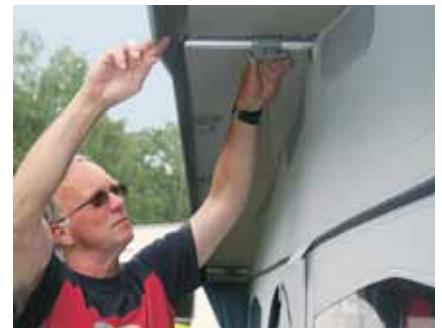
Ausbaufähig: Hohlsaumlaschen für Zusatzgestänge zur Vordachverstärkung.
