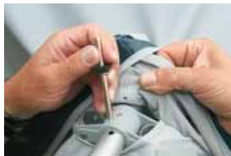
Schonend: Dorne werden zum Teil erst nach Überstreifen des Stoffes eingesetzt.
