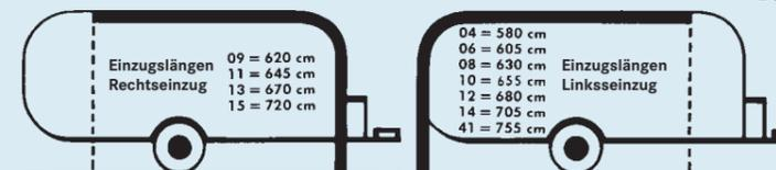
Nur das Einzugsmaß fixiert den Zeltabschluss am Wohnwagen – gemessen vom Boden – nicht Podest! Die Einzugslänge ist die Strecke bis zur Andrucklinie, ohne überstehendes Vordach. Optimale Passform wird erreicht bei Kederschienenhöhen von ca. 240 cm bis 250 cm.
